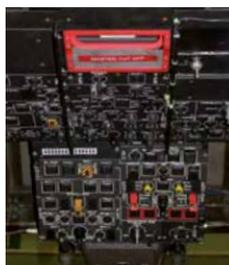
Durch Ziehen des roten Griffes (im Cockpit, Mittelkonsole überkopf) wird die Kraftstoffzufuhr und die elektrische Versorgung der Triebwerke unterbrochen.
