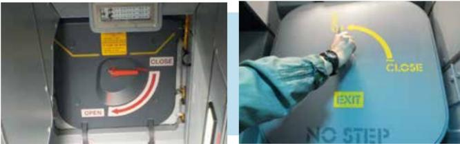
Die vordere Luke kann von innen und von außen durch Bewegen des Griffes in Pfeilrichtung geöffnet werden.
