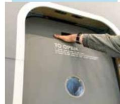
Zusätzlich befindet sich eine Notausstiegsluke rechts hinter dem Cockpit nach hinten versetzt.
