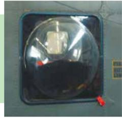
Die Fenster an der Rumpfmseite werden durch Ziehen an der roten Lasche aus dem Rahmen gelöst. Die gewölbte Scheibe lässt sich ebenfalls so lösen.
