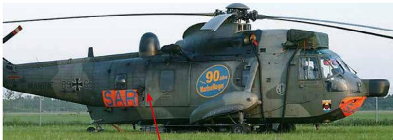
Die Schiebetür befindet sich auf der rechten Seite hinter der Fahrwerks gondel.
