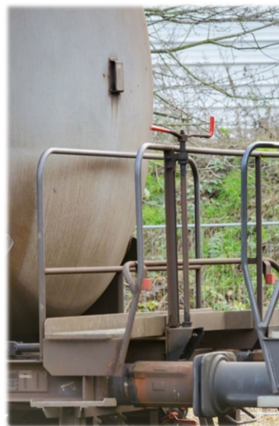
Abbildung 39: Feststellbremseinrichtungen auf der Pufferbrücke
