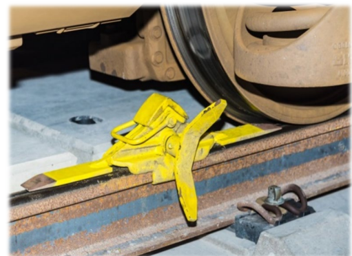
Abbildung 41: Radvorleger werden auf der Schiene befestigt
