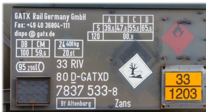
Abbildung 34: Anschriftentafel bei Kesselwagen mit Wagennummer, Lastgrenzenraster und orangefarbener Kennzeichnung
