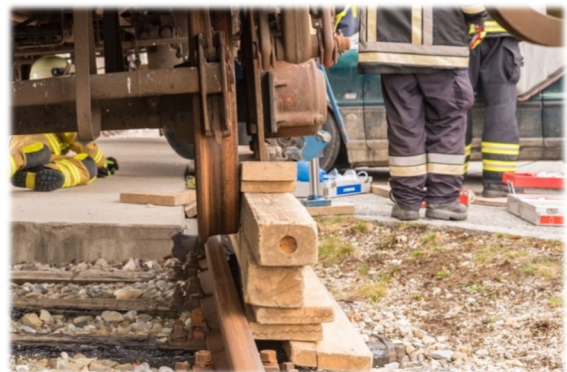
Abbildung 44: Sichern eines angehobenen Fahrzeugs durch Unterbau
