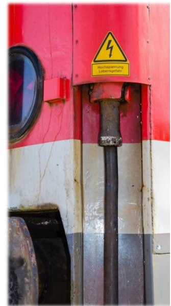
Abbildung 37: Nicht verbundene Zugsammelschiene an einem Reisezugwagen
