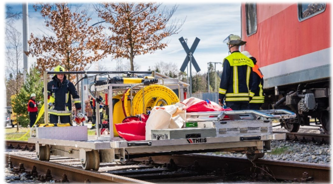
Abbildung 18: Die schienenengebundene Rollpalette ist Bestandteil des Rüstsatzes Bahn
