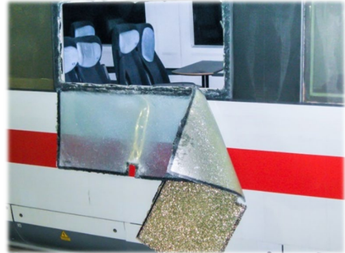
Abbildung 46: Notausstiegsfenster lassen sich nach außen wegdrücken
