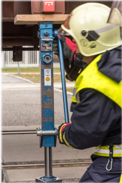
Abbildung 43: Anheben mittels Büffelheber
