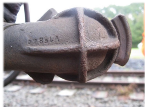
Abbildung 36: Gekennzeichneter Luftkopf einer Hauptluftbehälterleitung
