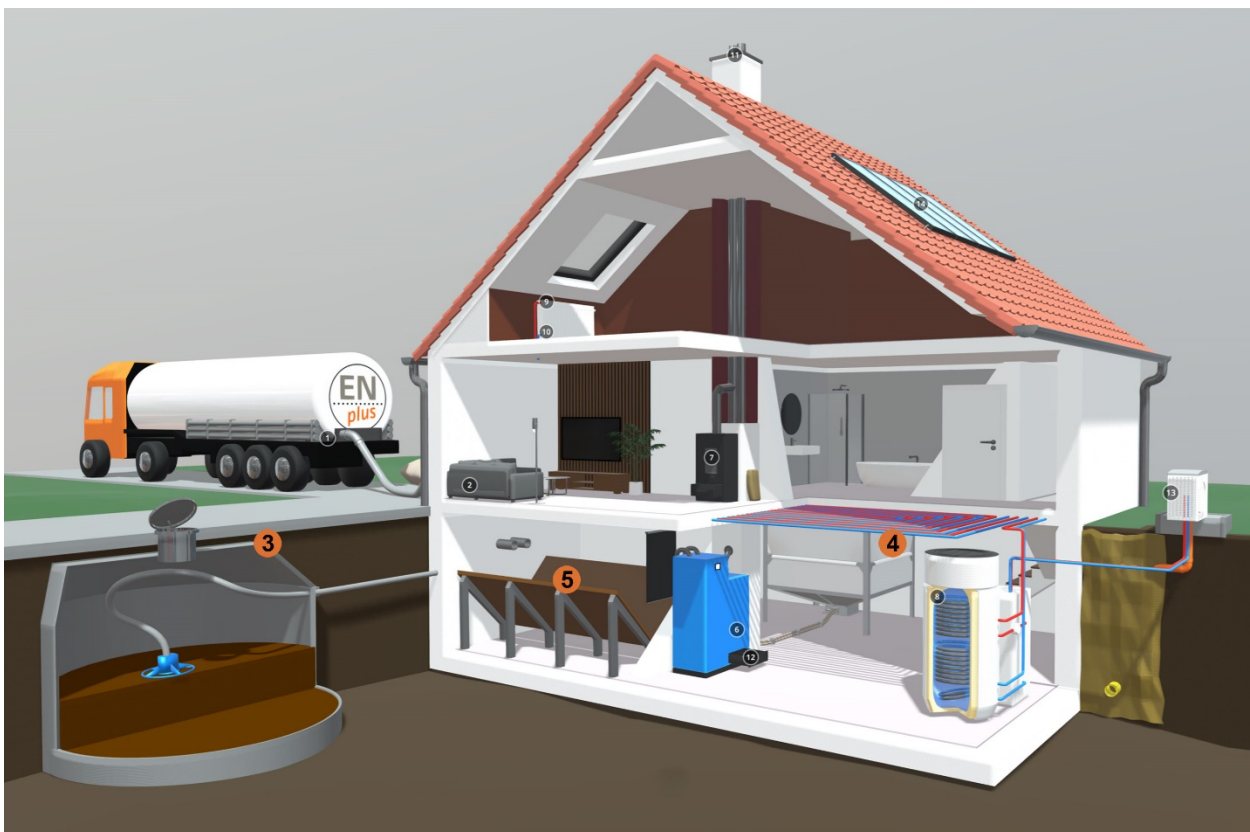
Darstellung gebräuchlicher Lagerarten, wie Erdlager (3), Sacksilo (4), Schrägbodenlager (5)
