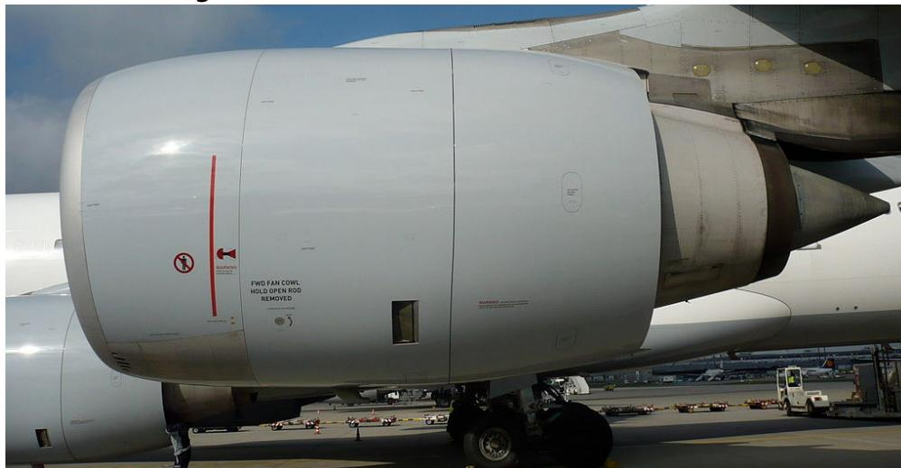
Eine seitliche Annäherung ist möglich, wenn die Person nicht weiter nach vorne geht als die rote Markierung die am Triebwerk angebracht ist.
