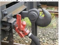
In der Regel wird die Betriebsbremse vom Führerstand aus betätigt. Diese wirkt auf alle Bremsen des Zugs und ist vorerst ausreichend für den Einsatz.
