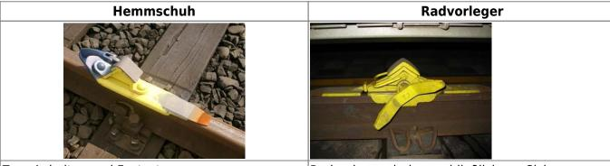
Zum Anhalten und Festsetzen von Schienenfahrzeugen. Hemmschuhe werden nur auf die Schiene gelegt, nicht befestigt. Radvorleger sind ausschließlich zur Sicherung stehender Fahrzeuge vorgesehen. Diese werden auf der Schiene befestigt.
