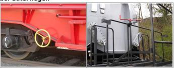
Güterwagen können über bodenbedienbare Bremsen oder über Spindelbremsen verfügen.
