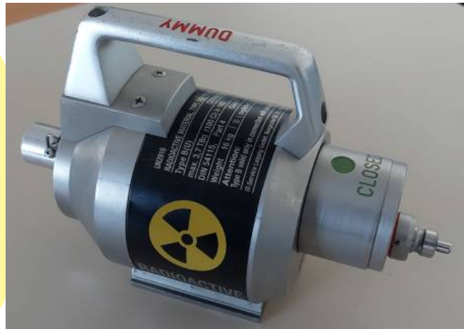
Gamma-Arbeitsgerät ohne Strahlerführung und Fernbedienung (Handkurbel)
