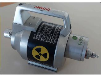
Gamma-Arbeitsgerät ohne Strahlerführung und Fernbedienung (Handkurbel)
