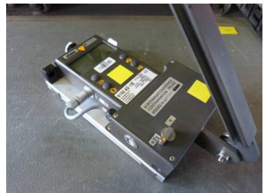
Das Kontaminationsnachweisgerät wird genutzt, um die Oberflächenkontamination von Personen und Objekten festzustellen. Außerdem dient es der Messung der Nullrate. Die Messeinheit ist **Impulse** pro Sekunde (Imp/s bzw. IPS) oder gleichbedeutend 1/s.
