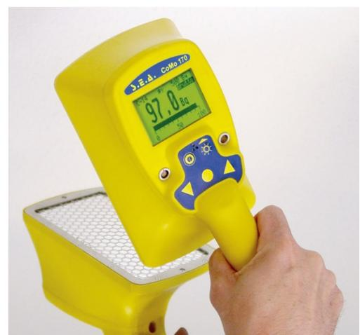
Beim Betrieb des zählgasfreien Plastiksintillationsdetektors muss ebenfalls beachtet werden, dass die Mylarfolie unbeschädigt ist. Eine Leckage der Mylarfolie, die den eigentlichen Plastiksintillationsdetektor vor Lichteinfall schützt, ist durch einen erhöhten Nulleffekt schnell festzustellen. Sie kann durch den Austausch des Folienrahmens (bei größeren Beschädigungen) oder durch Abkleben (Punktleckage) mit lichtundurchlässigem Klebeband oder Ersatzfolie behoben werden.
