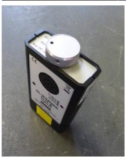
Das Dosisleistungswarngerät dient zur Festlegung der Grenze des Gefahrenbereichs (bei einer Dosisleistung von 25  $\mu$ Sv/h). Die Warnschwelle ist meist voreingestellt, kann aber teilweise geändert werden. Das Gerät registriert nur Gamma-Strahlung.
