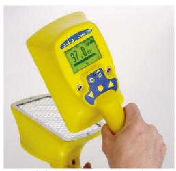
Beim Betrieb des zählgasfreien Plastikszintillationsdetektors muss ebenfalls beachtet werden, dass die Mylarfolie unbeschädigt ist. Eine Leckage der Mylarfolie, die den eigentlichen Plastikszintillationsdetektor vor Lichteinfall schützt, ist durch einen erhöhten Nulleffekt schnell festzustellen. Sie kann durch den Austausch des Folienrahmens (bei größeren Beschädigungen) oder durch Abkleben (Punktleckage) mit lichtundurchlässigem Klebeband oder Ersatzfolie behoben werden.
