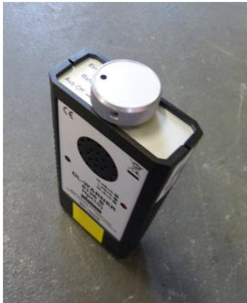
Das Dosisleistungswarngerät dient zur Festlegung der Grenze des Gefahrenbereichs (bei einer Dosisleistung von  $25 \mu\text{Sv}/\text{h}$ ). Die Warnschwelle ist meist voreingestellt, kann aber teilweise geändert werden. Das Gerät registriert nur Gamma-Strahlung.
