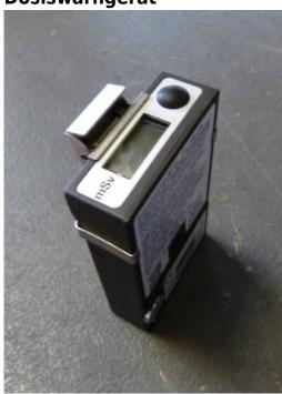
Das Dosiswarngerät alarmiert beim Erreichen der jeweils eingestellten Alarmschwelle. Diese sind, entsprechend der Referenzwerte (vormals Dosisrichtwerte), 20 mSv, 100 mSv, 250 mSv und 1 mSv. Es kann nur Gamma-Strahlung registrieren.
