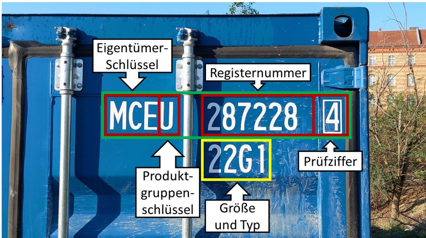
Der BIC-Code besteht aus vier Teilen. Er ist im Bild oben durch ein grünes Rechteck eingefasst:
