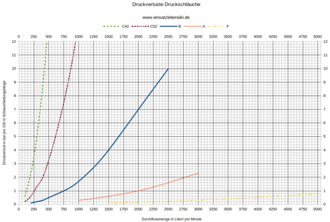
Druckverluste bei verschiedenen Schlauchgrößen (klicken um die Grafik in voller Größe zu öffnen)
