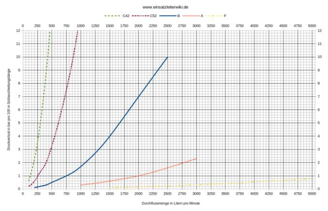
Druckverluste bei verschiedenen Schlauchgrößen (klicken um die Grafik in voller Größe zu öffnen)
