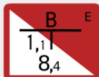
**Löschwasserbrunnen mit Tiefpumpe (Elektropumpe [E] oder**
