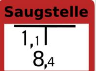
Kennzeichnung von Löschwasserentnahmestellen, Saugschächten und festverlegten Saugleitungen.
