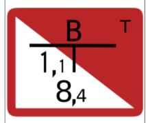
Löschwasserbrunnen werden nach DIN 14220 in 3 verschiedene Ergiebigkeitsklassen eingeteilt. Die Ergiebigkeit muss bei der Neueinrichtung über die Dauer von 3 Stunden nachgewiesen werden, bei den wiederkehrenden Prüfungen eine halbe Stunde.
