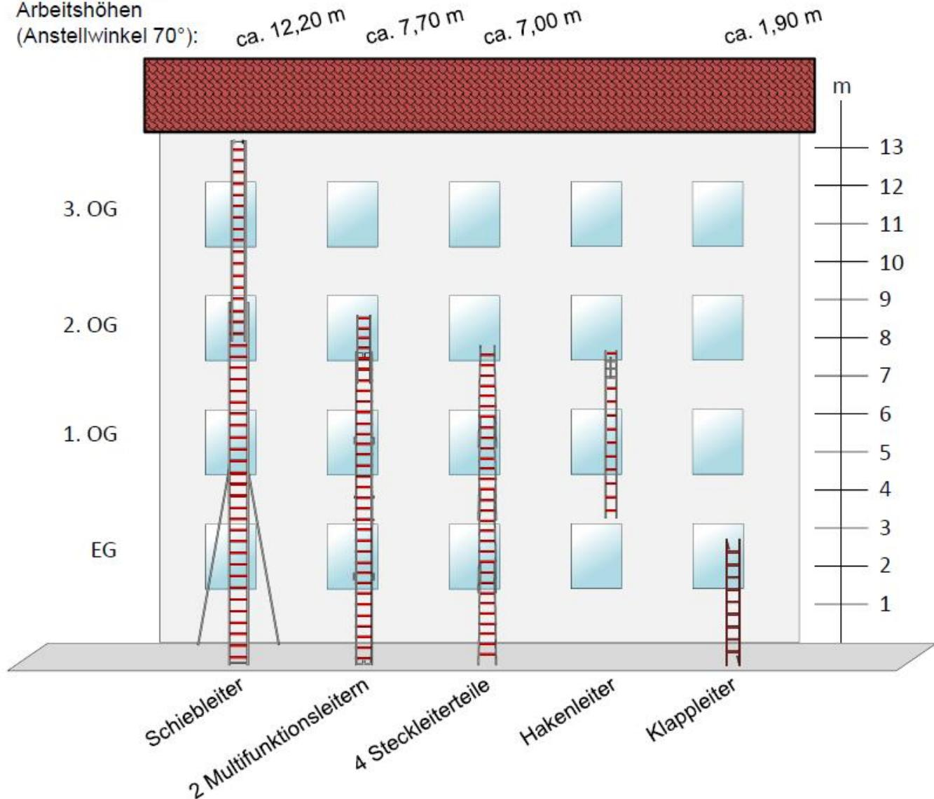
Für die erreichbaren Geschosse wird von 3 m Geschosshöhe ausgegangen. Bildquelle: FwDV 10
