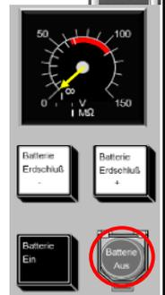
Achtung: Ohne Batteriespannung sind elektrische Einrichtungen (inkl. Notbeleuchtung) nicht aktiv.
