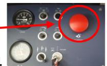
■ **Bei beschädigten Einbauteilen können im Bedarfsfall Restspannungen folgendermaßen komplett abgeschaltet werden.** Achtung: Dabei gehen auch alle Lichter im Fahrzeug aus!
